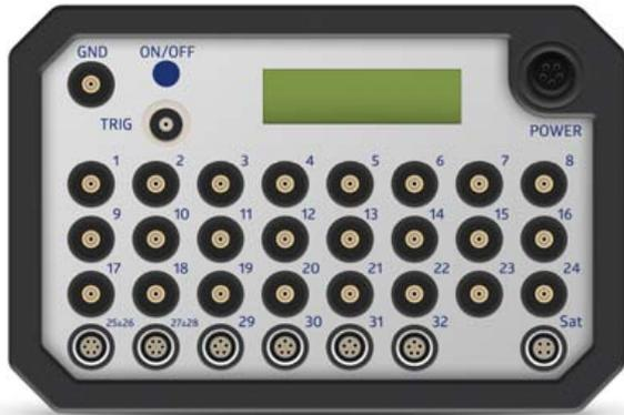
NeXus-32 bietet Forschern mit 24 EEG-Kanälen zahlreiche Möglichkeiten. Bis zu vier periphere Parameter können gleichzeitig abgeleitet werden. In der BioTrace+ Software sind Protokolle für QEEG, Kohärenz, Multichannel Monitoring, SCP, Alpha/Theta enthalten.
