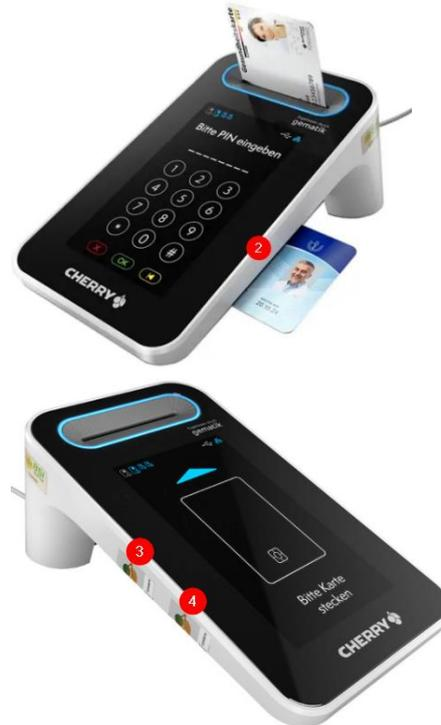
Bei den Slots 3 und 4 sitzt die alte SMC-B fest im Kartenslot. Um diese zu entfernen, *könnte* ein Siegel entfernt werden müssen, indem es aufgeschnitten wird (Messer, Schere). Anschließend nutzen Sie eine größere Karte (z.B. eine Versicherungskarte), um mit der Ecke der größeren Karte die alte SMC-B im Kartenslot leicht hineinzudrücken. Nach dem anschließenden Loslassen springt die alte SMC-B ein wenig heraus, sodass diese leicht entnommen werden kann.
